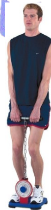
Слика 4. Аналоген динамометар за проценка на силата на мускулите екстензори на нозете
