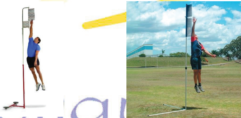
Слика 1. Vertec и Yardstick уреди за мерење на дофатна висина
