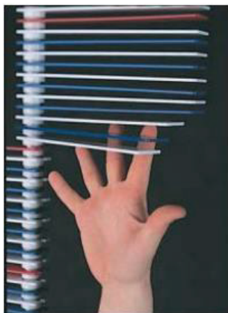
Слика 2. Последната поместена ресичка ја покажува максималната дофатна висина
