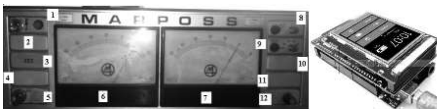
Slika 5. Akvizicioni analogni sistem MARPOSS i ARDUINO displej brusilice za kružno brušenje
