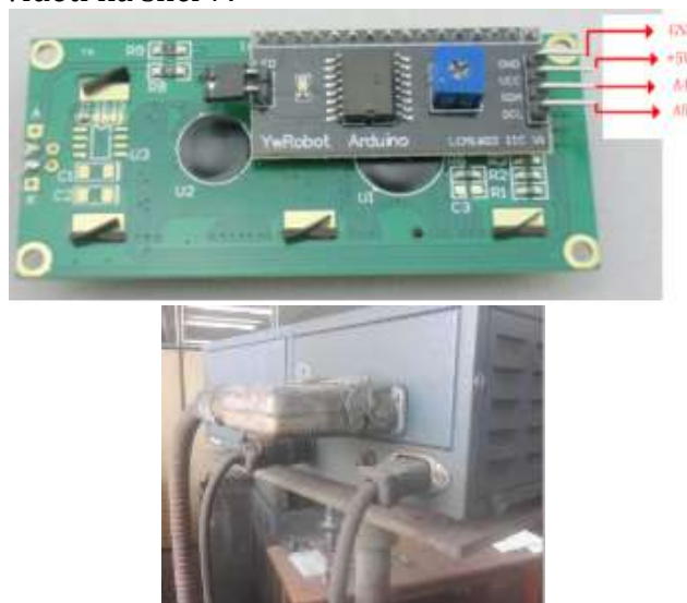
Slika 7. I2C i 1602 LCD Displej[8] i priključci MARPOSS
