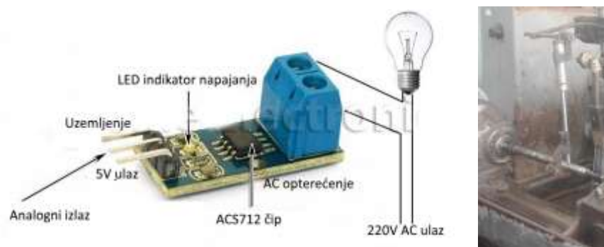
Slika 8. Ilustracija rada ARDUINO senzora ACS712 i senzor rastojanja MARPOSS[10]
