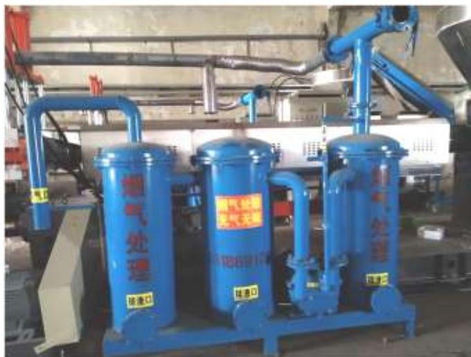
Slika 4. Sistem za prečišćavanje izduvnih gasova na ekstruderu
