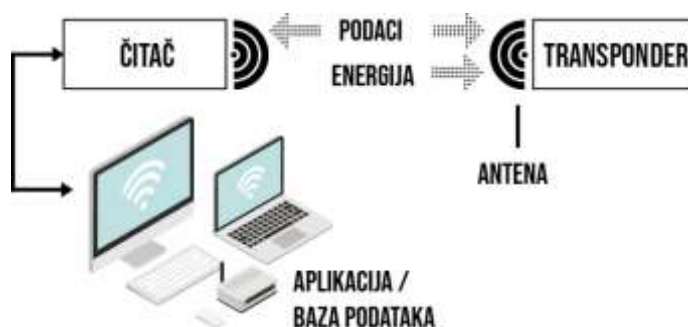
Slika 1. Primer funkcionisanja RFID sistema
