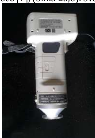
Slika 2. a).Konica Minolta Chroma Meter CR-400; b).Model CIE L^*a^*b^* sistem boja
