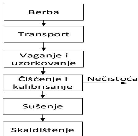
Slika 1. Blok šema tehnološkog postupka skladištenja lešnika
