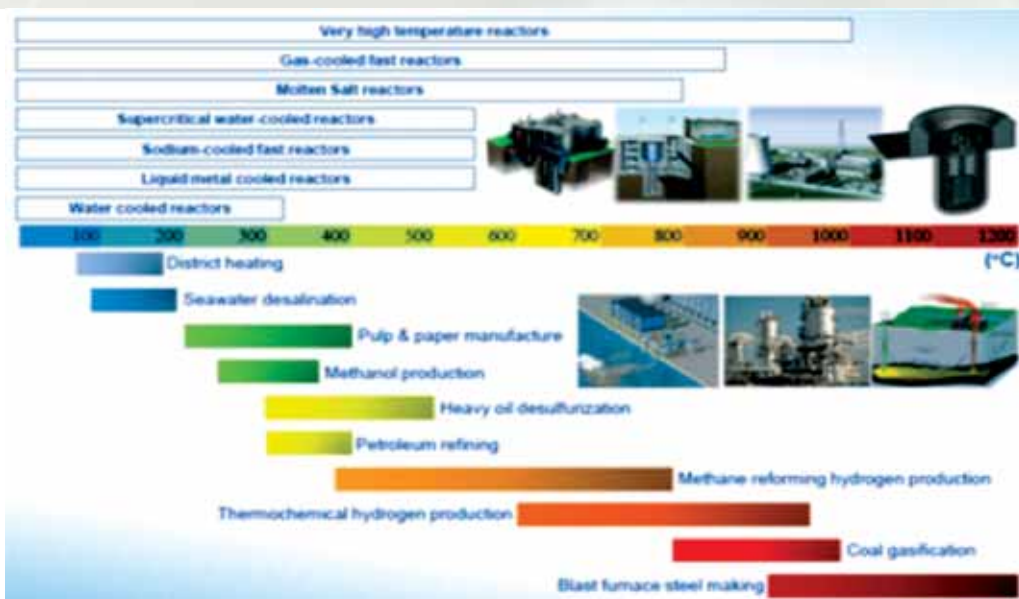
Слика 5. Користење на SMR за неелектрични цели (температура потребна на одредени процеси)
