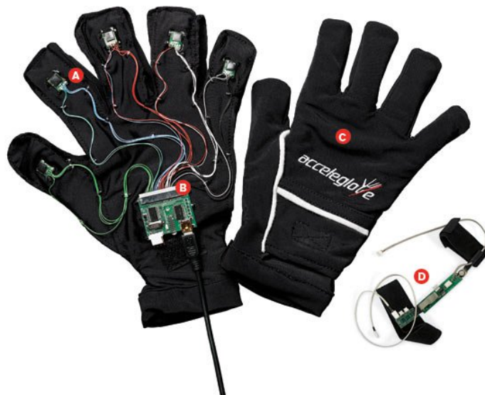
Слика 4.1: Податочна ракавица од компанијата AccelGlove (превземено од Wikimedia CC by 4.0)
