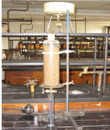
Слика 65. Колона за определување на водопропустливост
