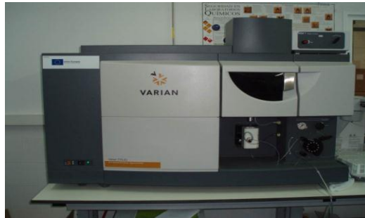
Слика 62. Атомски емисионен спектрометар со индуктивно спрегната плазма Varian 715 - ES
