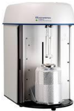
Слика 60. Микрометрички анализатор за специфична површина Tristar II 3020
