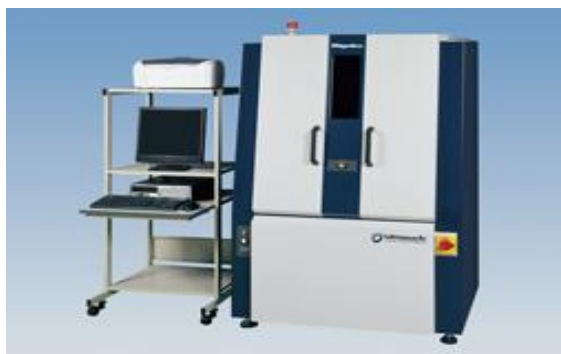
Слика 28. Rigaku Ultima IV рендгентски дифрактометар
