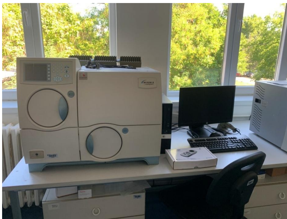
Слика 10. BioMérieux VITEK ® 2 Compact систем
