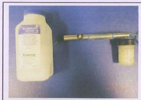
Сл. 16. Апарат за пескарее со алуминиум оксидни зрна
