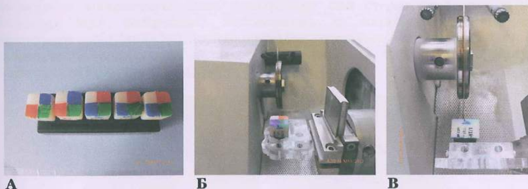
Сл. 21. А) „Сендвич“ блокови (по 5 за секој основен третман) Б) Блокот (фиксиран на основа од плексиглас) е поставен во Accutom В) Позиционирање и сечење на блокот со помош на дијамантско сечило монтирано во Accutom со цел добивање на микростапчиња
