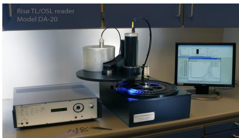
Слика 18. Читач на термолуминисценција и оптички стимулирана луминисценција, марка RISO TL/OSL DA 20 [76]
