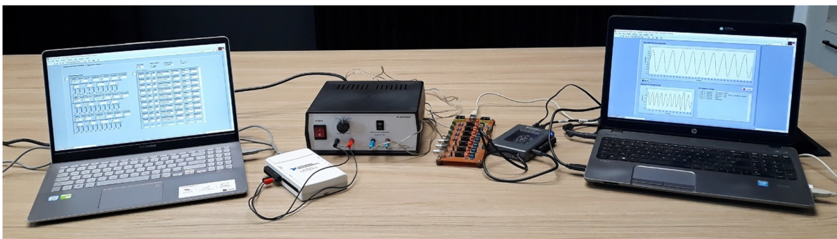
Слика 7-14. Ланец за верификација на системот за класификација на нарушувања на напонските сигнали во реално време
