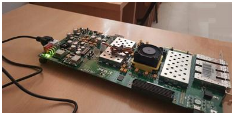
б) Симулација на MIMOPS процесор во реален хардвер.
