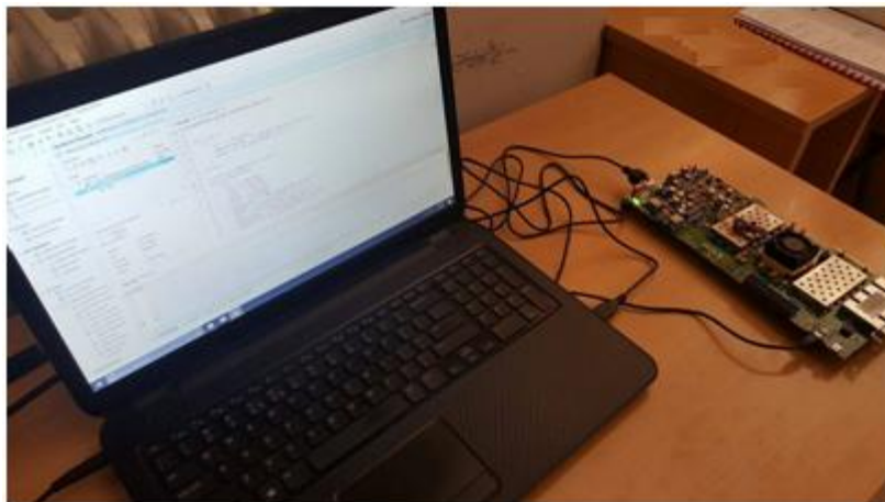
а) Програмирање на Virtex7 VC709 FPGA плоча со Xilinx IIMPACT алатка.
