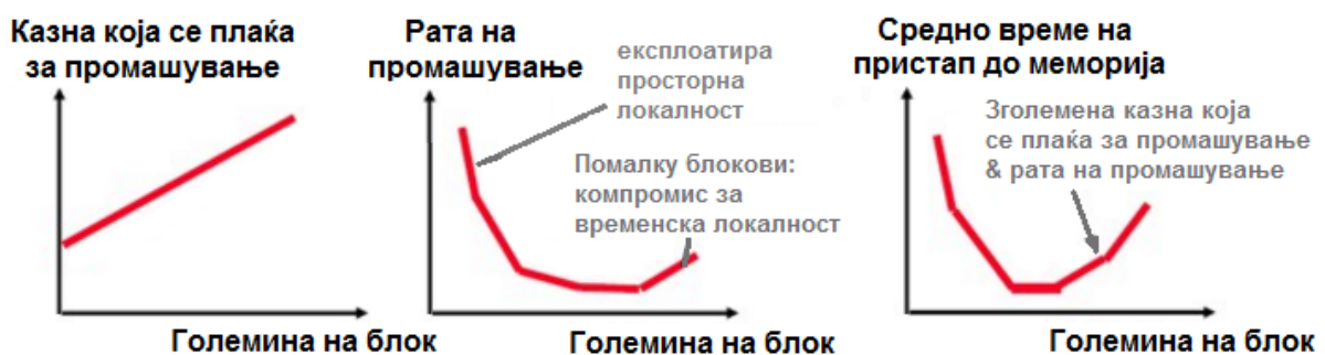
Слика 6 Влијание на големина на блок во кеш врз параметрите: казна која се плаќа за промашување, рата на промашување и средно време на пристап до меморија, [2].
