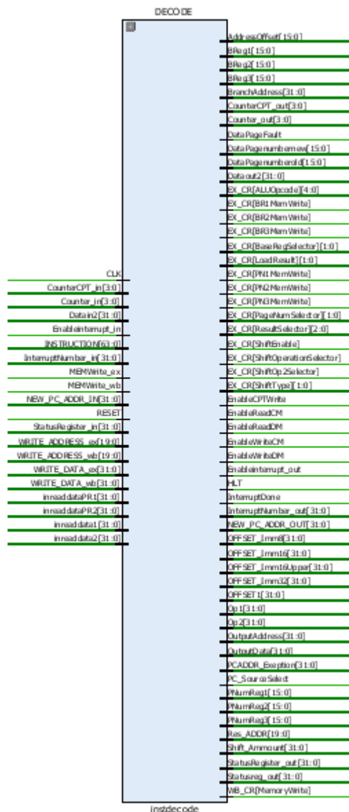
а) Интерфејси на VHDL модул за декодирање инструкција.
