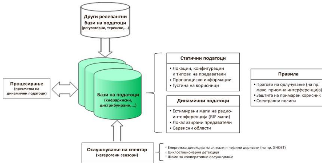
Слика 2.1: Генерички пристап за конструкција на REM
