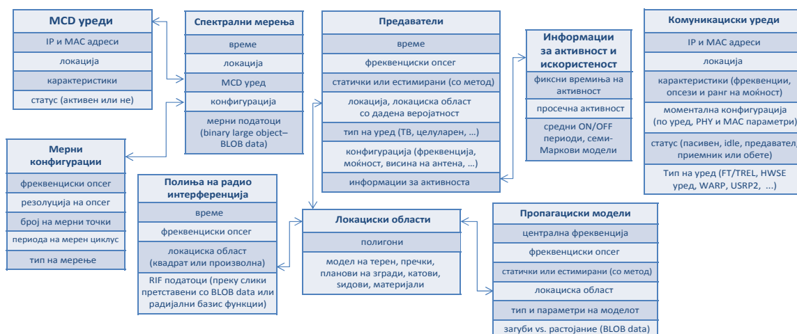
Слика 2.3: REM SA-податочна структура
