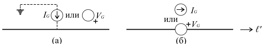
Слика 3.4 Два основни начини на побуда на заземјувачи (превземена од [Grc18b])
