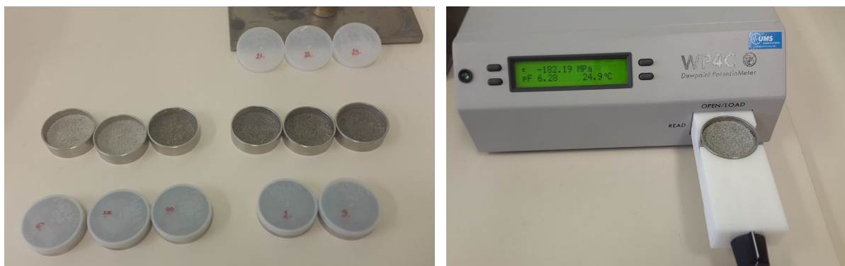
Слика 38. Мерење на хидрауличните карактеристики со Нурпор
