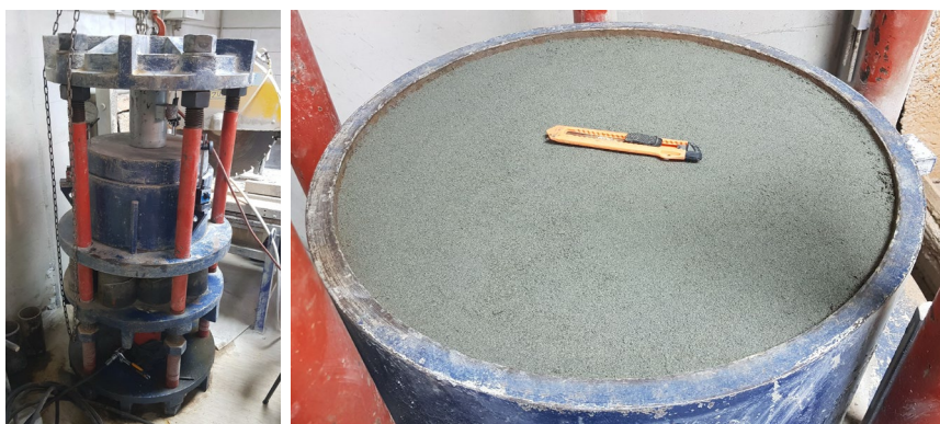
Слика 47. Едометар развиен во лабораторијата за геотехника при ГФ – УКИМ Скопје
