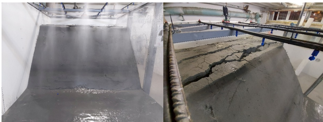
Слика 98. Состојба на ножицата на косината по 400 мин. и состојба на косината по 440 мин.
