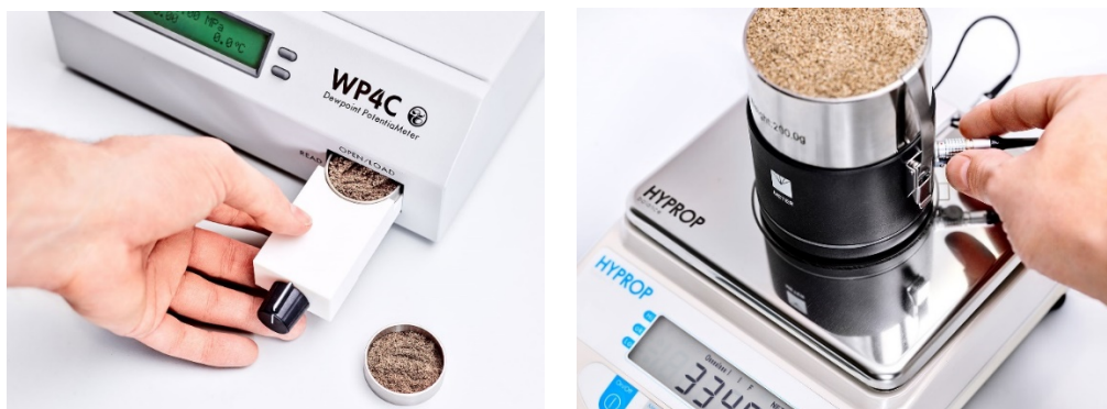
Слика 18. Мерење на вкупна сукуција со WP4C и HYPROP (Meter Group, 2020)
