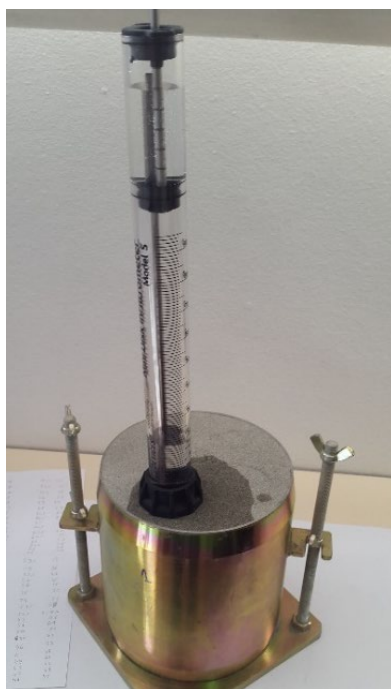
Слика 43. Испитување на незаситената хидраулична спроводливост со инфилтрометар
