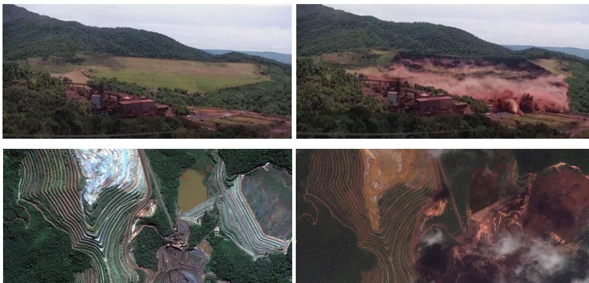
Слика 1. Пред и потоа. Свлекување на низводната косина на браната во 2019 година
