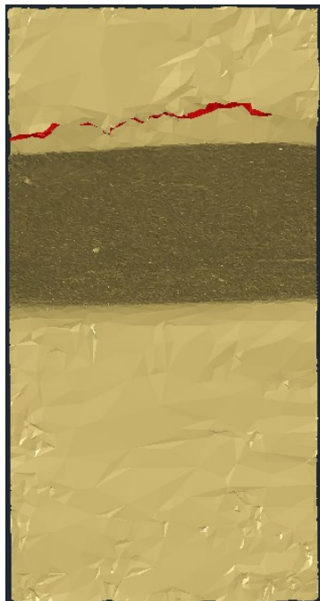
Слика 84. Местоположба на челна пукнатина
