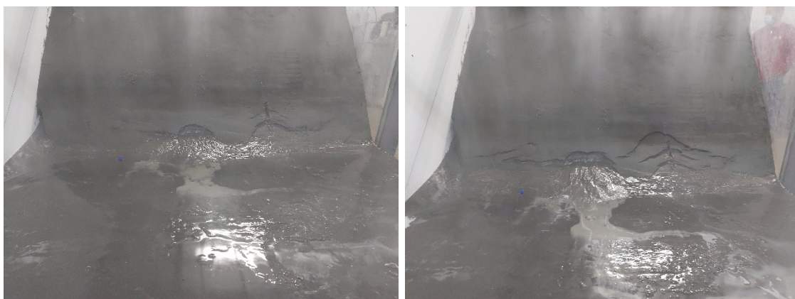
Слика 99. Состојба во ножицата на косината по 490 и 505 минути
