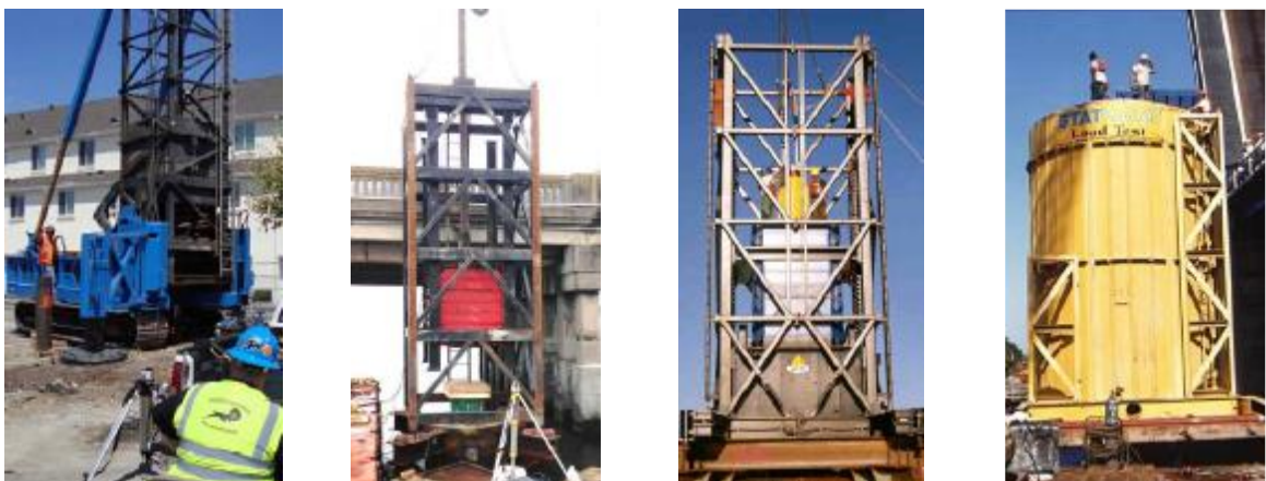
Слика 4.13. (а) масата на Fundex со тешко амортизирање на пружината, (б) амортизиран динамички тест, (с) Статичко товарење со механизам за зафаќање, (д) Статичко товарење со склад за задржување на чакал (за поголеми оптоварувања)
