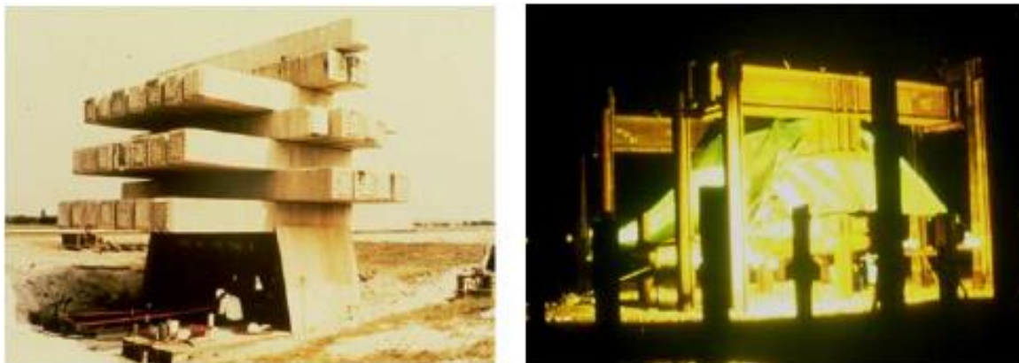
Слика 4.9. Испитување при статичко товарење со мртов товар (лево) и реактивна рамка (десно)
