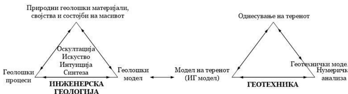
Слика 4.3. Врска меѓу методите на истражување и анализа во инженерската геологија и геотехниката низ т.н. инженерскогеолошки и геотехнички триаголник (според Ц. Нил, 2003)
