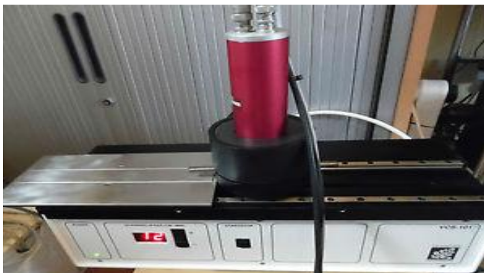
Сл 2. Гама хроматограмски скенер - Veenstra Chromatogram Scanner VCS-101
