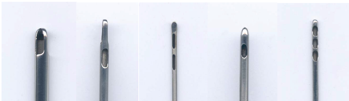
Слика 6: Различни видови на канили (од лево кон десно): канила со Мерцедес кружен врв, канила со кобра врв, канила со шпатула врв и два отвори, канила со еден отвор, канила со три отвори во вертикална рамнина
