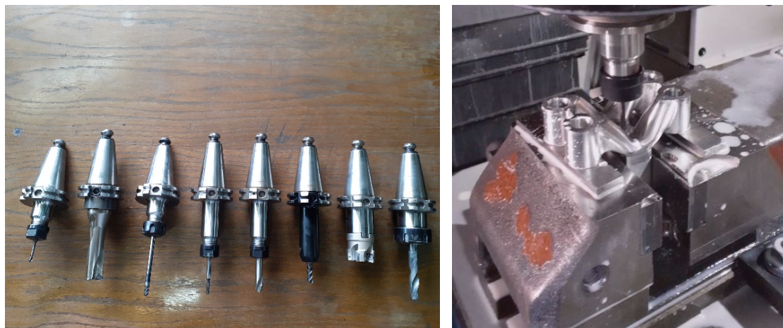
Слика 4.28: CNC обработка: (лево) алати; (десно) операција на глодање.
