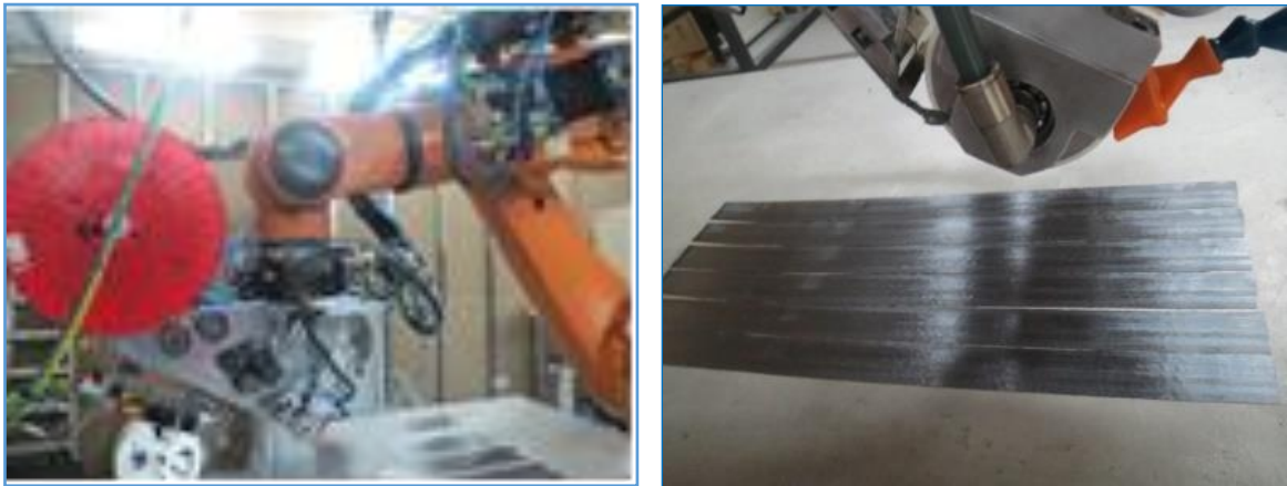
Слика 6.2. Полагање на UD1 и UD2 препрег ленти со помош на глава за ATL автоматско полагање со примена на ласер за загревање, произведена од Микросам, Р. Северна Македонија
