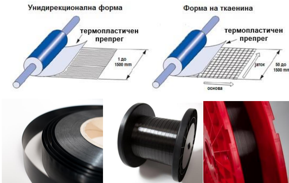
Слика 2.5. Различни видови на препрег материјали [15, 17]
