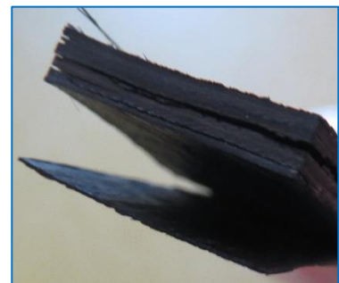
Слика 7.3. Изглед на примерок LATL UD1 серија 6 после тестирање
