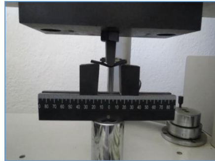
Слика 6.10. Подготвени примероци и тестирање на еден примерок
