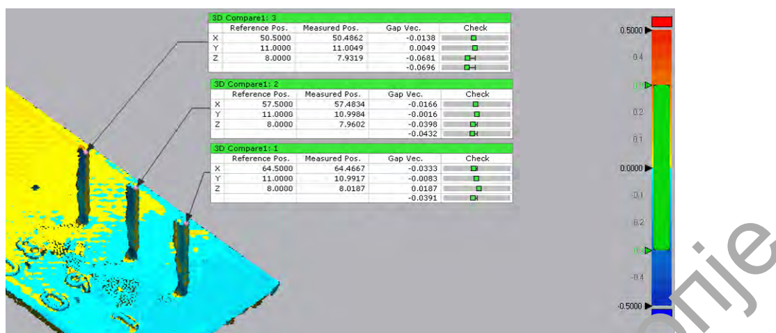
Слика 4-10. Описување во обликот на изработеното парче 1-3а во 3D околина (сојствено исцражување)
