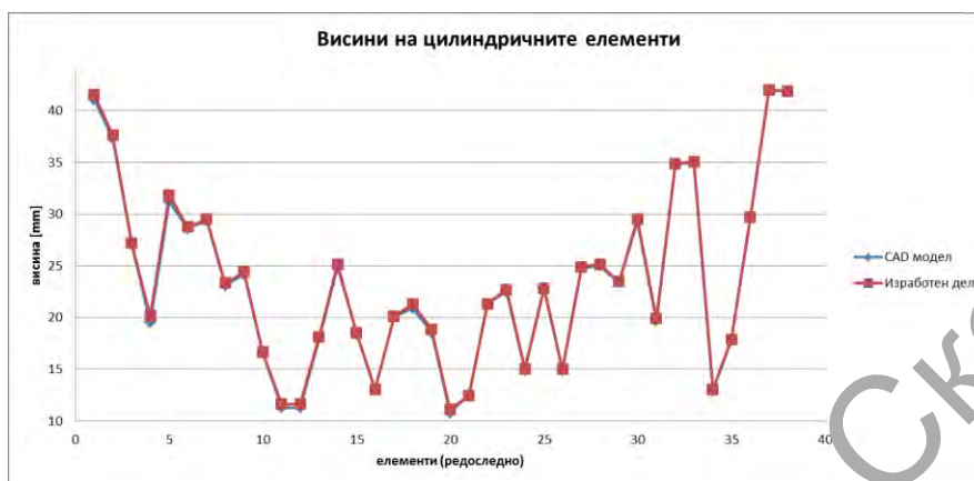
График 4-2. Вредности за висината на цилиндричните елементи на CAD моделот и изработениот парче (сојсвивено исцражување)
