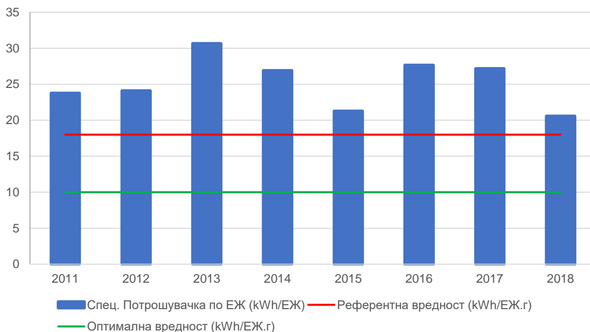
Слика 5.10: Специфична потрошувачка на електрична енергија по ЕЖ.г за системот за аерација за периодот 2011-2018
