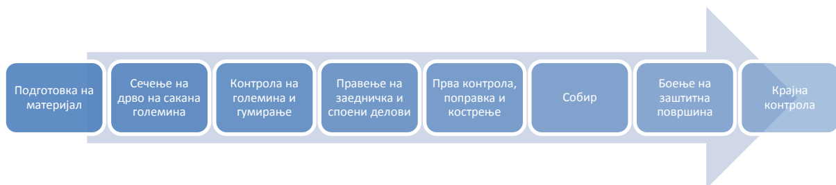
Слика 28. Типичен процесен дијаграм на дрвена табла. Figure 28. Typical process diagram of a wood Table.
