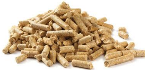
Слика 18. Облик на пелети изработени од струганици од дрво Figure 18. Shape of pellets made of wood shavings
