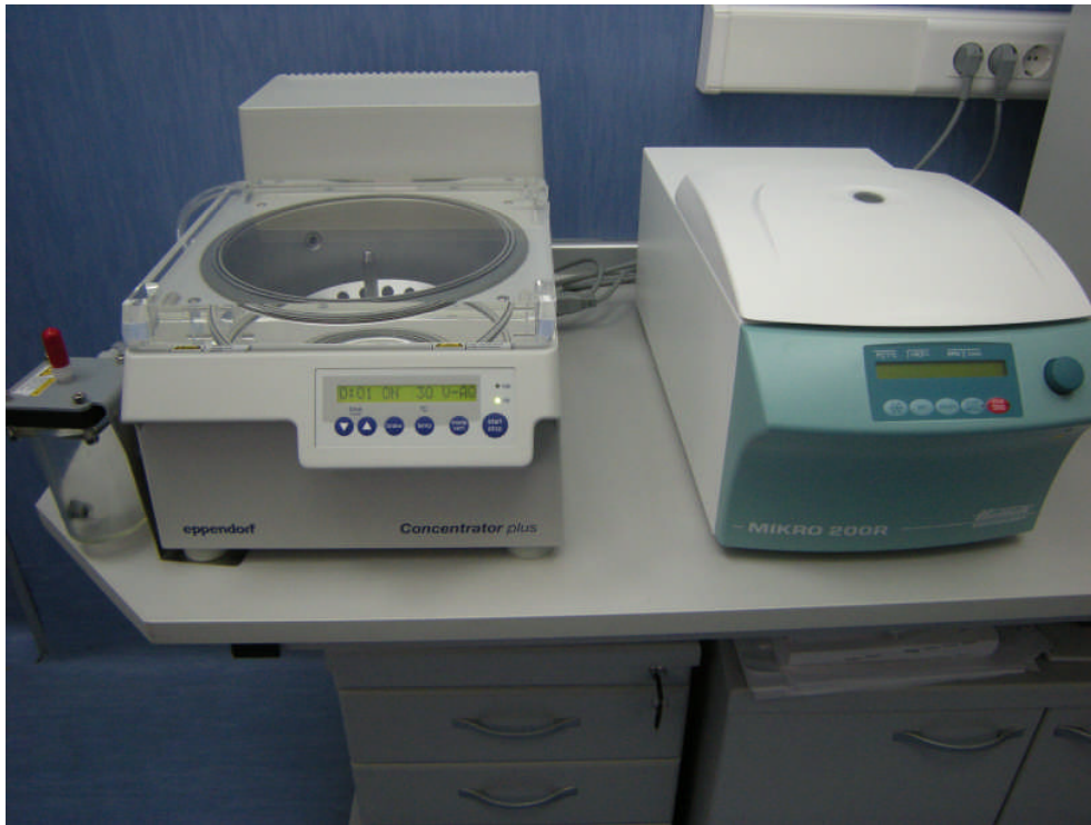
Слика 11. Прикажани се вакуум-центрифуга - Concentrator plus, Eppendorf, во која се врши испарување на прочистените реакции на секвенционирање до сув продукт и десно е прикажана центрифуга - Mikro 200R, Hettich.
