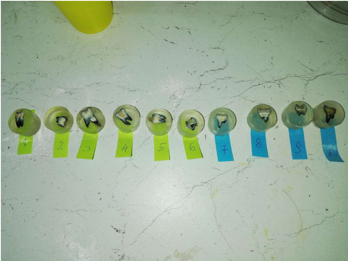
Слика 24 Подготовка на примероците за СЕМ анализа
