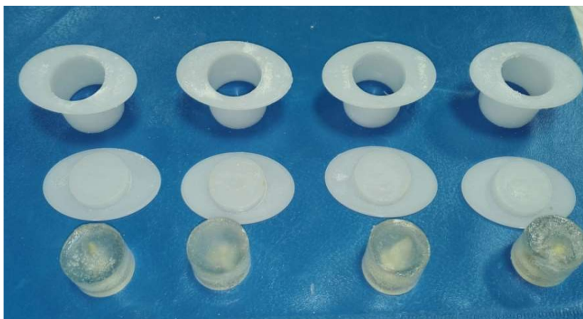
Слика 3 Отстранување на примерокот од калапот
