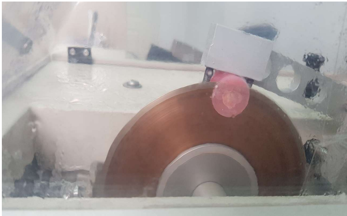
Слика 6 Сечење на истражувачкиот примерок
