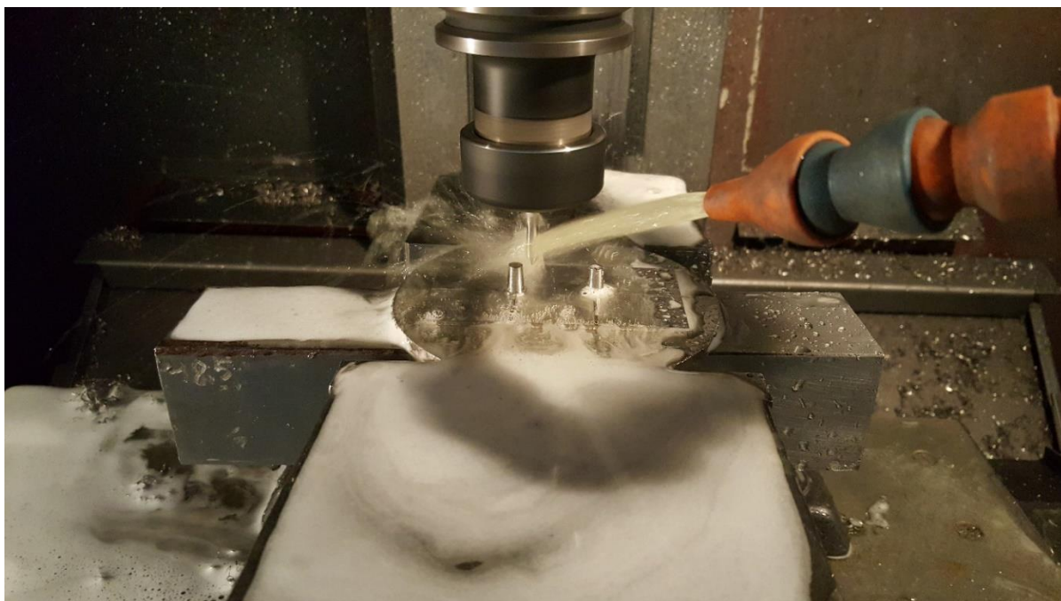
Слика бр.1 Мастер модел при изработка во ЦНЦ машина
