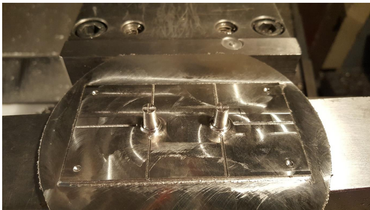
Слика бр.2 Мастер модел во ЦНЦ машина
