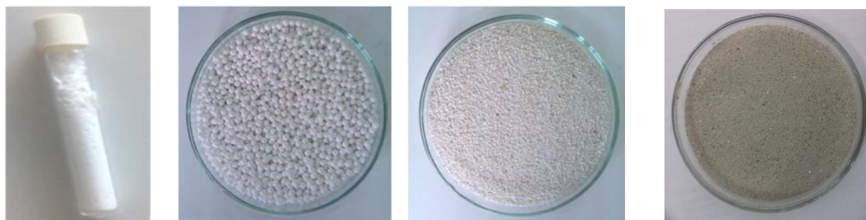
а) б) в) г) Слика 19. Користени катализатори а) ZSM-5, б) \text{Al}_2\text{O}_3 , в) туф, г) кварцен песок
