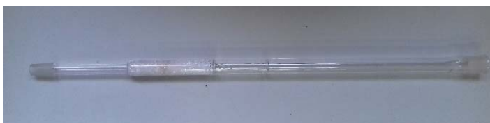
Слика 22. Цевен реактор од Pyrex стакло
