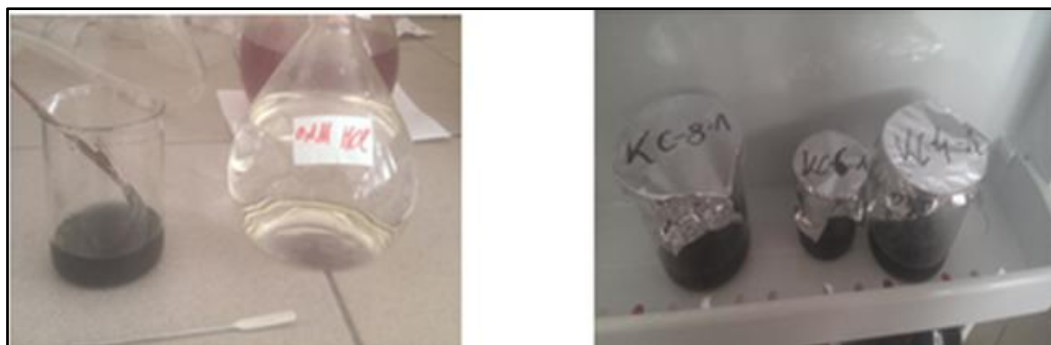
а) допинг на нанокмозитот во 0,1 М НСl за време од 24 h
