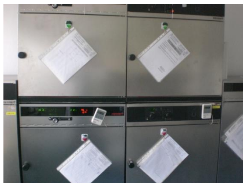
Слика 14. Изглед на термостати (Mettmert INE 500), во кои се врши инкубацијата на засеаните подлоги и бујони
