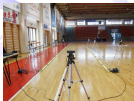
Слика 4. Сериски поврзани оптички подлоги синхронизирани со систем на фотокели
