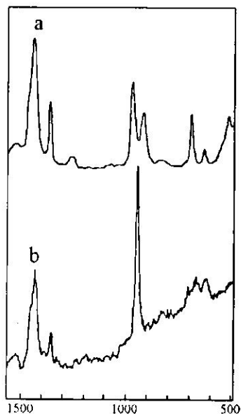
Сл. 23 – Рамански спектри на протиран \text{Ni}(\text{CH}_3\text{COO})_2 \cdot 4\text{H}_2\text{O} (a) и на неговиот деутериран аналог (b)
